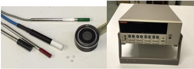
Camera a ionizzazione Rivelatore al silicio Rivelatori a diamante Elettrometro Kithley 6517A
