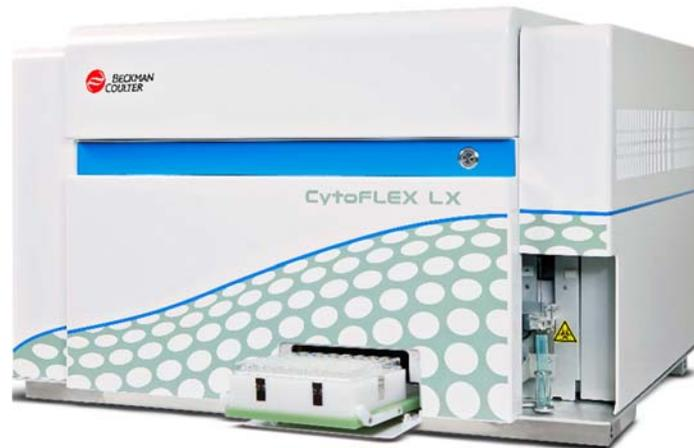
La serie di citometri a flusso CytoFLEX LX rappresenta l'evoluzione della famiglia CytoFLEX. Il sistema CytoFLEX LX è un portfolio di citofluorimetri che possono essere configurati a partire da un minimo di 4 laser - 14 colori ad un massimo di 6 laser - 21 colori. Questa flessibilità di scelta delle configurazioni consente di dotare un laboratorio di ricerca della combinazione di laser più adeguata alla tipologia di sperimentazione multicolore che vi si svolge.
